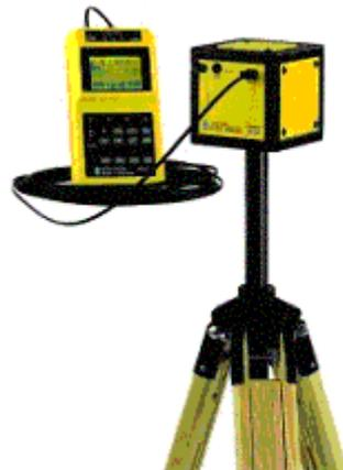
Bild 17. Analysator des Feldes EFA-3 (Firma "Wandel & Goltermann")
